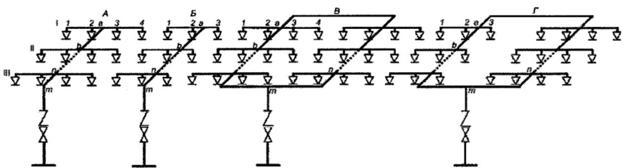
А - тупиковая секция с симметричным расположением оросителей; Б - тупиковая секция с несимметричным расположением оросителей; В - секция с симметричным кольцевым питающим
