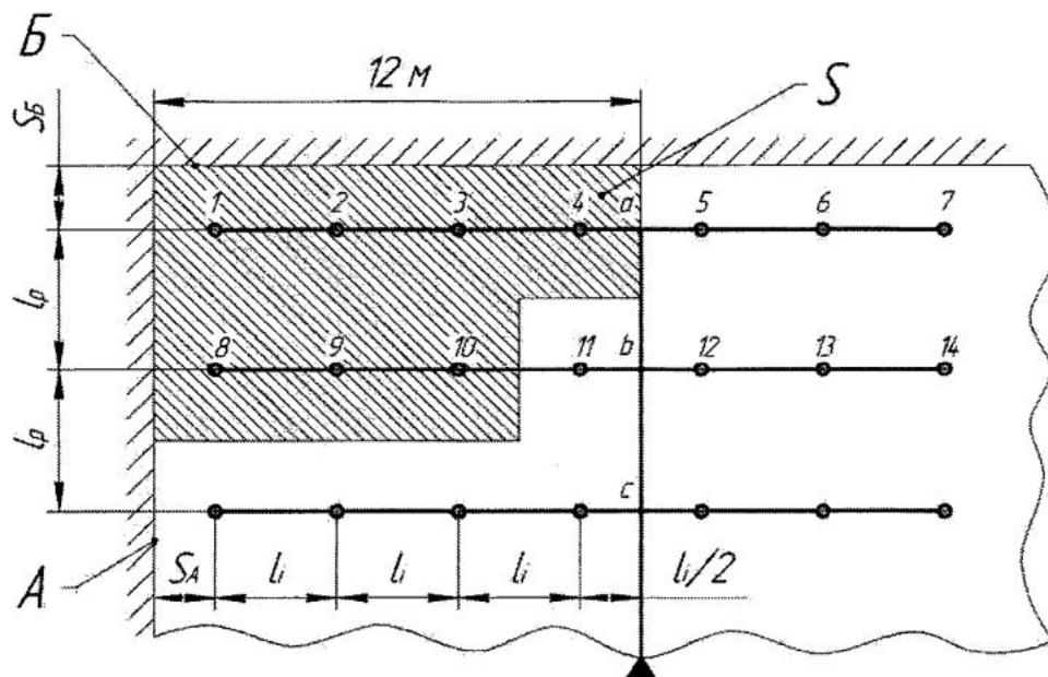
1 - 14 - оросители;  $l_i$  - расстояние между оросителями в рядке;  $l_p$  - расстояние между рядками;  $S_A$  - расстояние от крайних оросителей до стены А ( $S_A \leq l_i / 2$ );  $S_B$  - расстояние от наиболее удаленного ряда до стены Б ( $S_B = l_p / 2$ );  $S_d$  - защищаемая орошением диктующая зона (не менее
