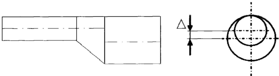
Рисунок 6.1 - Устройство несоосного перехода труб
